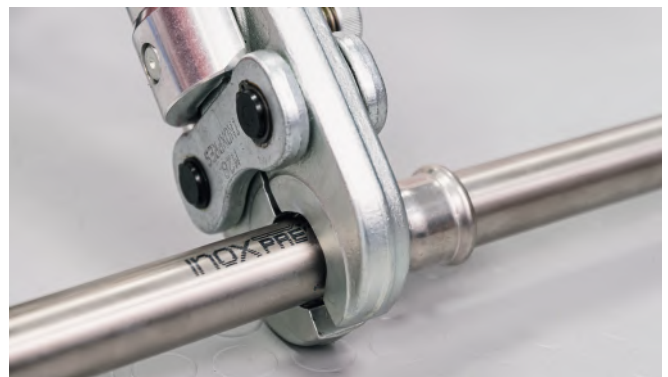
Bild 32 - Herstellen der Pressverbindung
